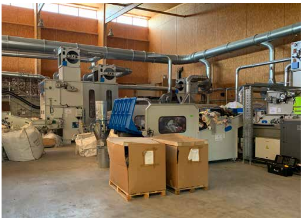
Ouatéco a développé un savoir-faire unique en France de découpe, délissage (séparation des textiles des matières dures), puis d'effilochage par 5 tambours successifs équipés de pointes.
