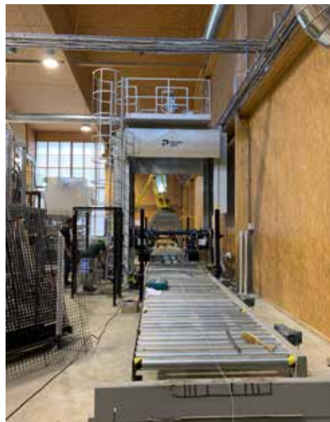
Ouatéco a développé un savoir-faire unique en France de découpe, délissage (séparation des textiles des matières dures), puis d'effilochage par 5 tambours successifs équipés de pointes.
