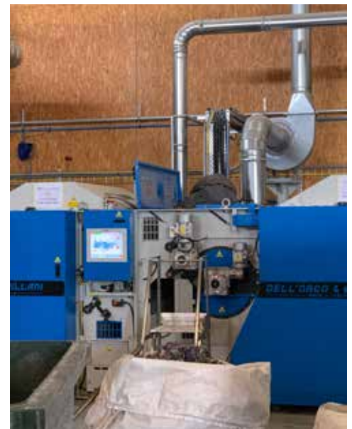
Ouatéco a développé un savoir-faire unique en France de découpe, délissage (séparation des textiles des matières dures), puis d'effilochage par 5 tambours successifs équipés de pointes.
